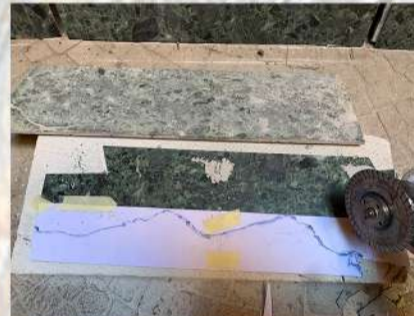
II FASE: taglio della lastra secondo il rilievo
