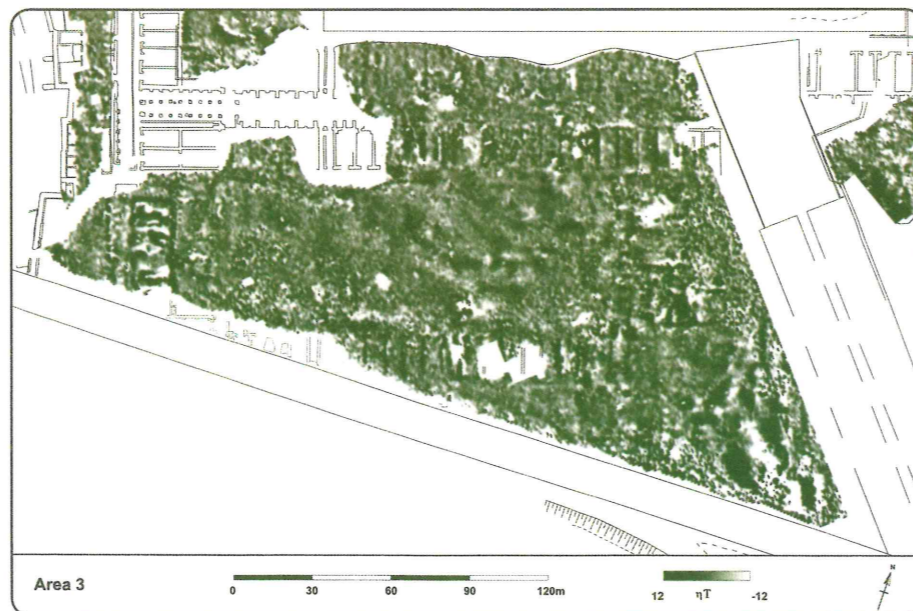
Risultati delle rilevazioni magnetometriche del Foro Olitorio
